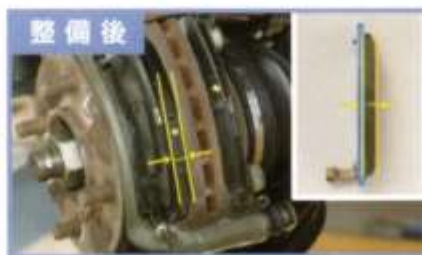
ブレーキ・パッドが新品の状態
