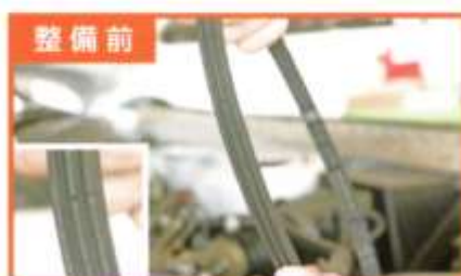
補機ベルトに損傷がある状態（写真は車両から取り出した状態）
